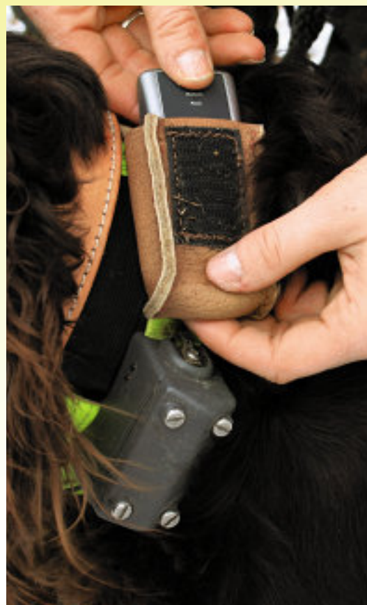
Der GPS-Datenlogger wurde in einer Ledertasche an der Halsung sicher befestigt.
